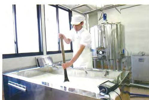
温度を少し上げながら攪拌して、水分が抜けるのを促進します。
